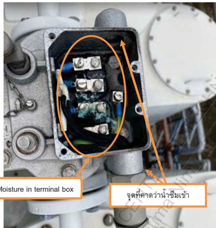
รูปที่ 1 Terminal box ที่ความชื้นเข้าและจุดที่คาดว่าความชื้นเข้า
